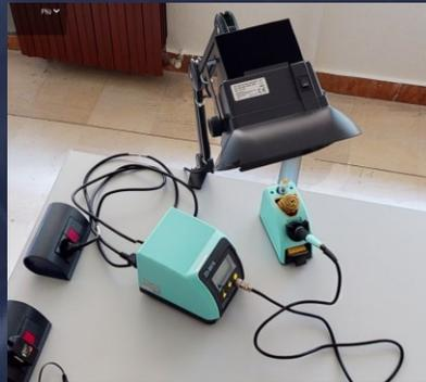
Dispositivi IoT inseriti nelle prese da banco dove sono collegati sia gli strumenti che le attrezzature.
